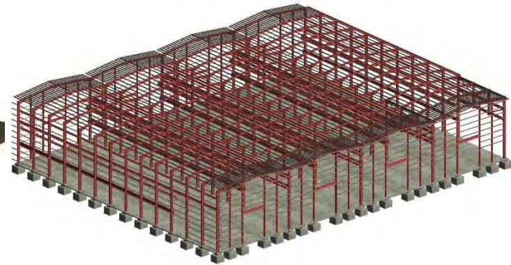
Modelo Estrutural – Revit Structure
